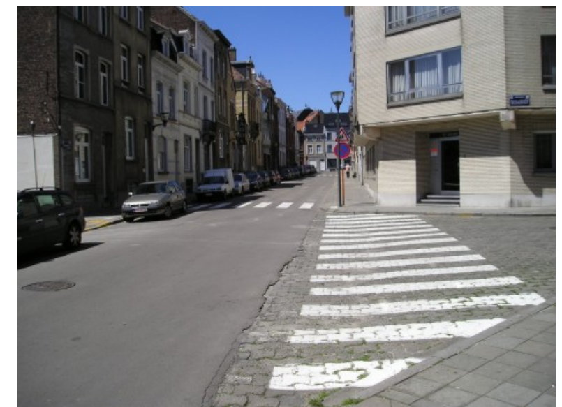
Rue Delcoigne (carrefour avec la rue de la Sécurité) : ni oreilles de trottoirs, ni abaissement du trottoir au droit de la traversée piétonne.
